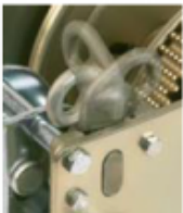
Ciquet réversible 3 positions (montée, descente, neutre)
