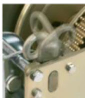
Ciquet réversible 3 positions (montée, descente, neutre)
